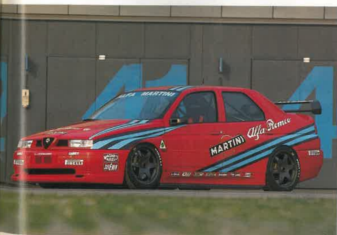
UN ENORME POTENCIAL El Alfa Romeo 155 GTA, con tracción integral y casi 400 caballos, es uno de los favoritos al título.
