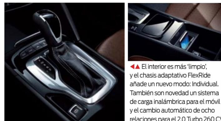
◀ El interior es más 'limpio', y el chasis adaptativo FlexRide añade un nuevo modo: Individual. También son novedad un sistema de carga inalámbrica para el móvil y el cambio automático de ocho relaciones para el 2.0 Turbo 260 CV.
