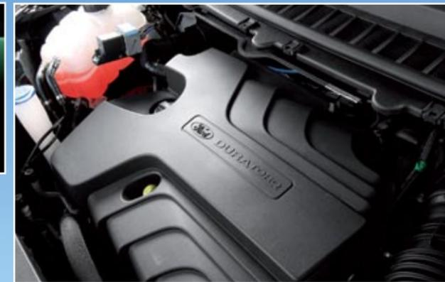
◀ Los tres modelos enfrentados comparten el motor diésel Duratorq 2.0 TDCi de 180 CV y la tracción total AWD, elemento éste que viene de serie en todos los Edge y que en Mondeo y S-Max supone un extra de 3.000 euros respecto a las versiones de tracción delantera.
