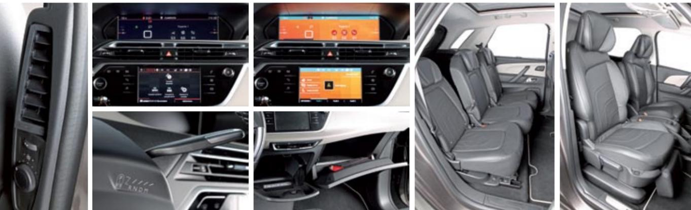
▶ La amplitud interior es sensacional y los asientos traseros se pueden reclinar o desplazar hasta 130 milímetros. Hay multitud de pequeños huecos para dejar objetos, y detrás cuenta con salidas de ventilación. Las pantallas son configurables, y la posición del cambio es muy particular.
