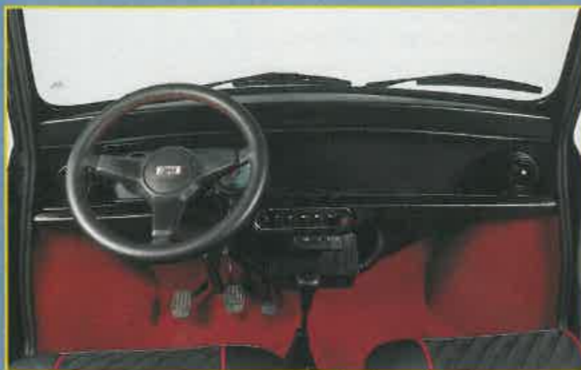
POCO ORTODOXO Los pedales, desplazados hacia la derecha y el volante en posición casi horizontal, obligan a una postura forzada de conducción.
