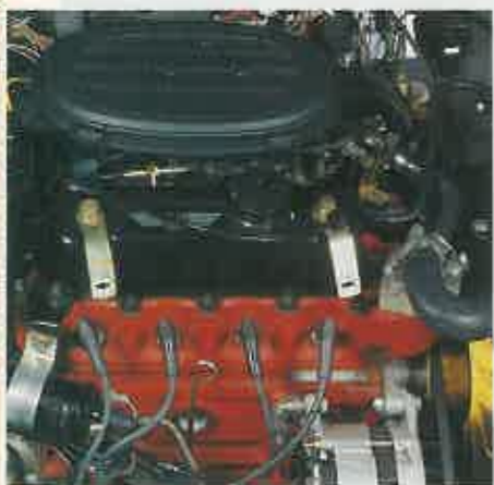
REVOLUCIONARIO EN SU ÉPOCA La disposición del motor en posición delantera transversal marcó un hito en su época.
