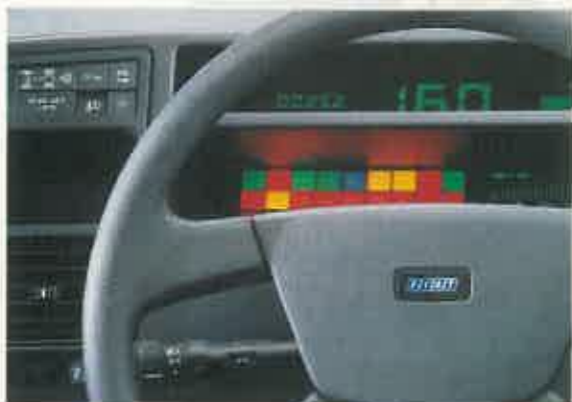
BLOQUEO DE DIFERENCIAL El Fiat Tempra Station Wagon 4WD cuenta en el salpicadero con un tecla para bloquear el diferencial trasero.
