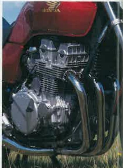
carburadores tipo CV achaflanados, la refrigeración del aceite por cartucho y las válvulas, pistones y cigüeñal, en los que se ha buscado ligereza, rigidez y máxima eficacia. La respuesta es muy brillante: 14 caballos a 10.500 revoluciones y un par de 9 mkg a 8.500. Para aprovechar este motor se cuenta con un cambio de seis velocidades, bien escalonado y que funciona con una suavidad digna de todo encomio.
