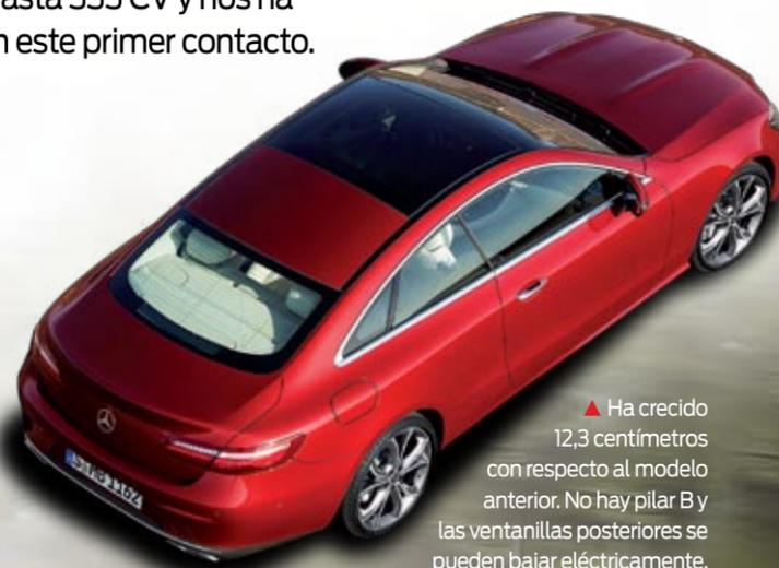
▲ Ha crecido 12,3 centímetros con respecto al modelo anterior. No hay pilar B y las ventanillas posteriores se pueden bajar eléctricamente.
