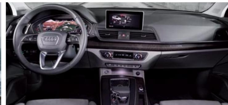
▲ En opción ofrece el Audi Virtual Cockpit, con pantalla configurable de 12,3 pulgadas para la instrumentación. La pantalla central mide 8,3 pulgadas.
