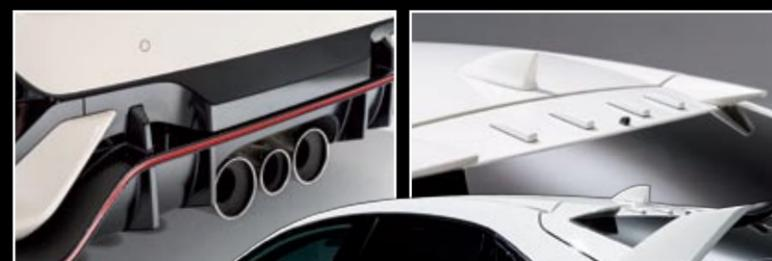
◀ La espectacular zaga del Civic Type R introduce novedades aerodinámicas, como los generadores de vórtices del techo o el nuevo diseño del alerón.
