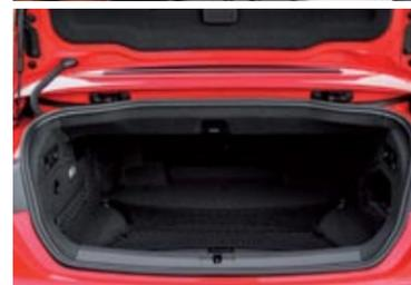
El maletero cubica 380 litros, y 320 si plegamos el techo. La bandeja de seguridad permite siempre el mayor volumen.
