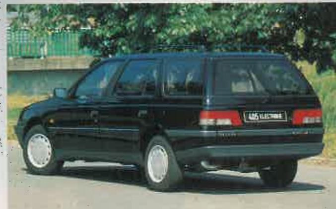
PEUGEOT 405 ELECTRICO Se le puede considerar híbrido pues dispone de un motor diésel.
