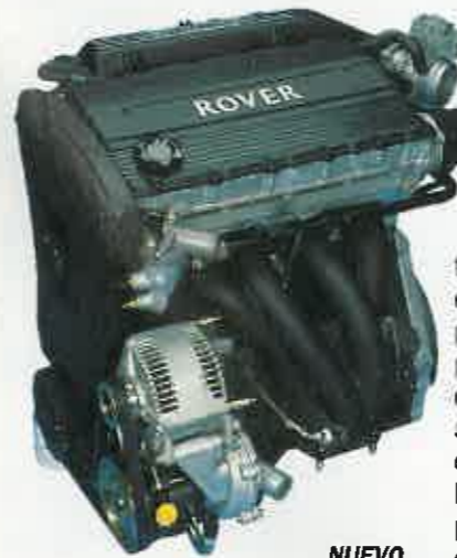
NUEVO MOTOR El dos litros Serie T incorpora culata de dieciséis válvulas y dos árboles de levas.
