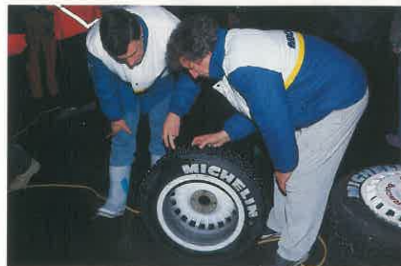
COMO GARRAS Las fuertes implantaciones de clavos en los neumáticos, permitidos en Suecia, hacen segura la conducción sobre hielo.
