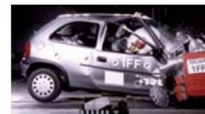
**OPEL CORSA.** ★★★★★ Los 'crash test' desvelaron excesiva intrusión de los pedales y «débil» protección del abdomen.
