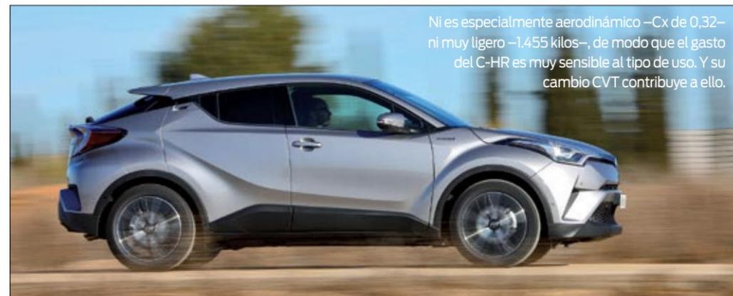
Ni es especialmente aerodinámico –Cx de 0,32– ni muy ligero –1.455 kilos–, de modo que el gasto del C-HR es muy sensible al tipo de uso. Y su cambio CVT contribuye a ello.
