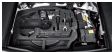
▲ Los 580 litros de maletero incluyen un doble fondo y, debajo de ese espacio, otro hueco para el kit de reparación y la batería.
