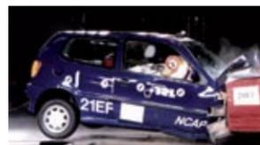
**VW POLO.** ★★★★★ No se libró de una «excesiva» intrusión de los pedales y una «pobre» protección de las costillas.
