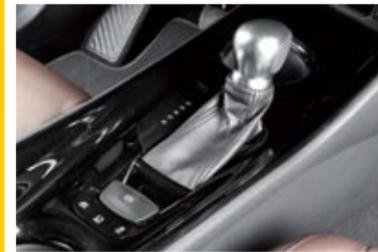
◀ Junto al selector del cambio automático, que tiene un modo 'B' específico para fuertes descensos, va el gatillo del freno de parking. Y como en otros híbridos, no hay cuentavueltas pero sí un potencímetro o el monitor de funcionamiento de la mecánica.
