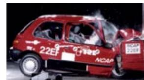
**NISSAN MICRA.** ★★★★★ Principales defectos: intrusión excesiva de los pedales y protección del abdomen por debajo de los mínimos.
