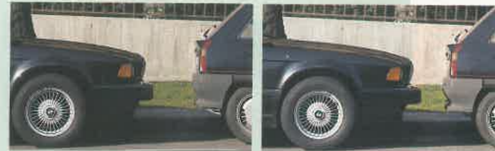
MUY PRECISO En la foto de la izquierda, el PDC ha captado el obstáculo, mientras que en la de la derecha, el sonido interior comienza ya a pitar de forma permanente.
