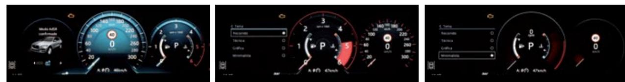
▲ El cuadro de instrumentos de 12,3 pulgadas tras el volante se puede configurar con diferentes vistas, permitiendo dar más importancia a una u otra información. Por ejemplo, en modo Sport el reloj del cuentavueltas se impone al resto. Y en el modo ECO, al revés.
