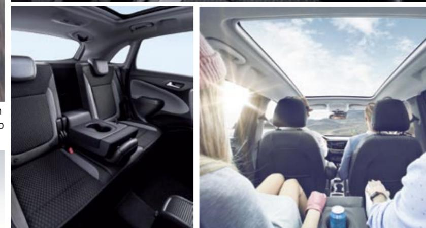
▲ Interior muy espacioso, con grandes dotes de modularidad como el asiento posterior regulable longitudinalmente y abatible por secciones. Usa la Plataforma 1 de PSA, procedente del 2008, pero el salpicadero tiene una marcada personalidad Opel, nada que ver con el i-Cockpit del Peugeot.
