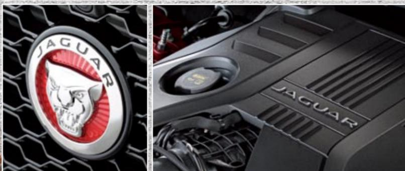
◀ El motor turbodiesel de seis cilindros en V y 300 caballos de potencia mueve el conjunto con fuerza siempre de sobra. Y es raro ver consumos superiores a los 9,0 l/100 km de media.
