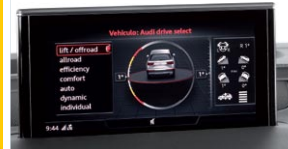
▲▼ Siete son los modos de conducción, incluyendo el Offroad, el menos apropiado para este SQ7. El cambio es un Tiptronic de 8 velocidades con convertidor de par.
