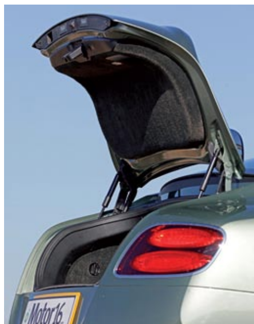
▶▶ El maletero cubica 358 litros y esconde una rueda de repuesto de emergencia con la que, en teoría, no se puede pasar de 80 km/h. La tapa del maletero es automática. Y la boca de carga, algo estrecha. Pero todo está rematado a la perfección.
