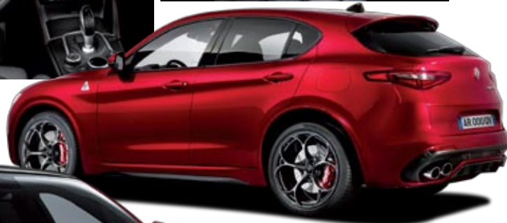
◀ La primera versión del Stelvio mostrada es la Quadrifoglio, que combina un 2.9 V6 Biturbo de 510 CV –con desconexión de cilindros– y el cambio automático ZF de 8 marchas.
