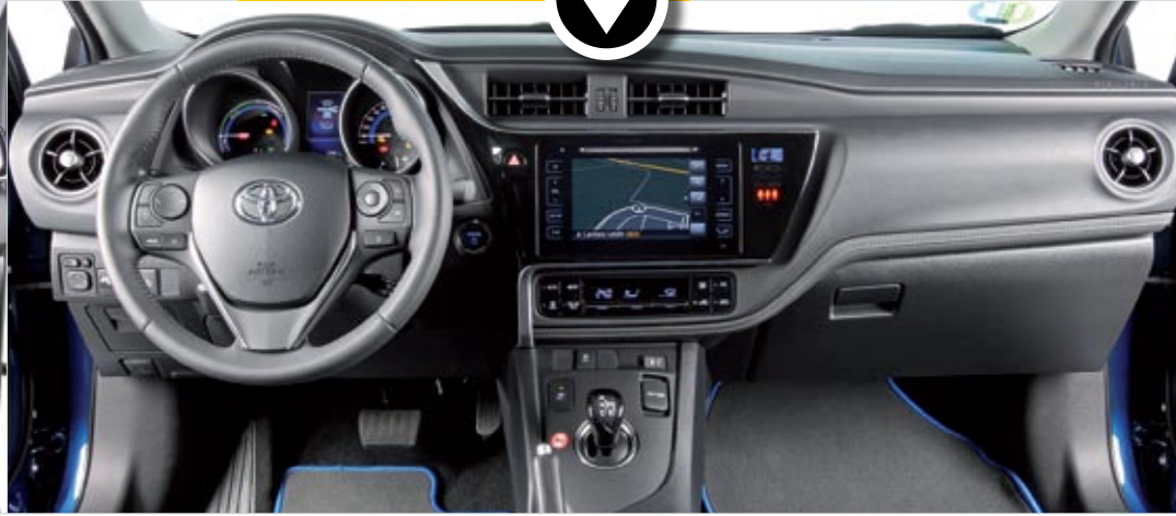
◀◀ Frente al conductor, similares panoramas en los dos coches: volante multifunción, velocímetro a la derecha y potenciómetro con medidor de recarga a la izquierda, display con información extra en el centro...
