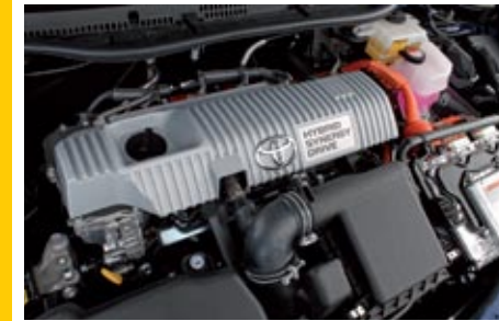
▲▼ Ambos usan un cuatro cilindros de gasolina de ciclo Atkinson, pero Kia emplea inyección directa en su 1.6 GDI y Toyota prefiere la indirecta en el 1.8 VVT-i. Abajo, las baterías 'normales'.
