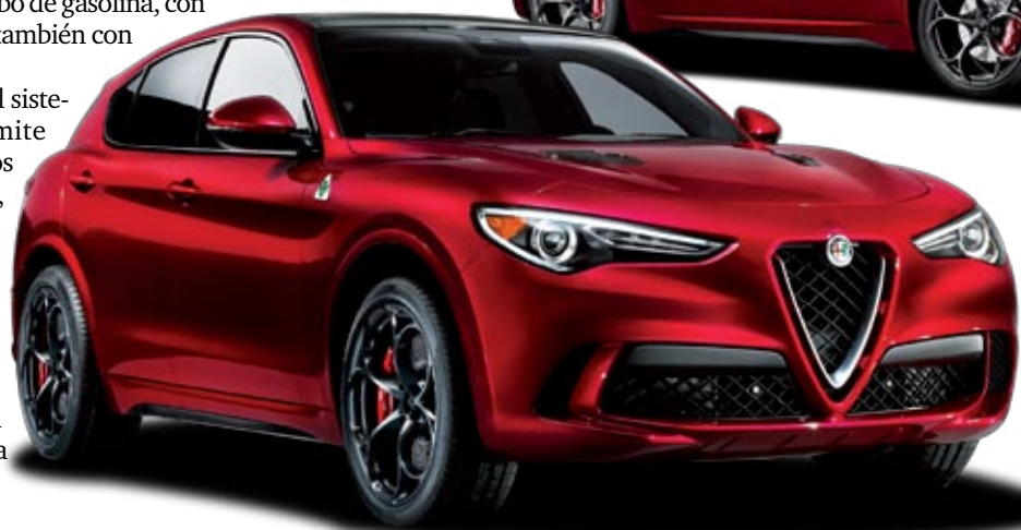
◀ La primera versión del Stelvio mostrada es la Quadrifoglio, que combina un 2.9 V6 Biturbo de 510 CV –con desconexión de cilindros– y el cambio automático ZF de 8 marchas.
