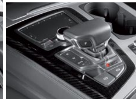
▲▼ Siete son los modos de conducción, incluyendo el Offroad, el menos apropiado para este SQ7. El cambio es un Tiptronic de 8 velocidades con convertidor de par.
