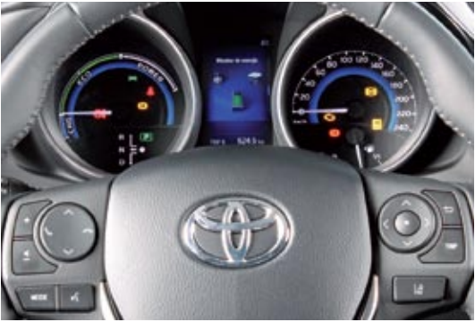
◀◀ Frente al conductor, similares panoramas en los dos coches: volante multifunción, velocímetro a la derecha y potenciómetro con medidor de recarga a la izquierda, display con información extra en el centro...
