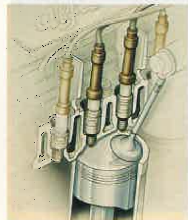
TECNOLOGÍA ALFA ROMEO El dibujo superior muestra el motor de cuatro cilindros en línea Twin Spark. Es la evolución del típico motor Alfa Romeo de doble árbol de levas en cabeza, con cruce variable. El dibujo inferior enseña una particularidad del doble encendido que utiliza dos bujías por cilindro.
