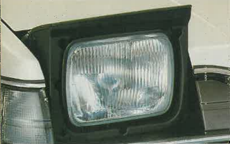
Los faros son escamoteables Cuando van escondidos mejoran el coeficiente aerodinámico
