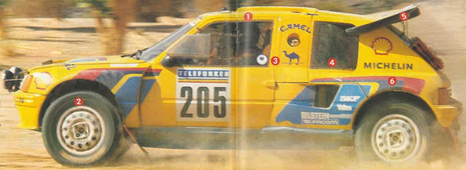
1 Luces de posición reglamentarias. Son obligatorias para todos los participantes. Tomas de aire para el motor y habitáculo. El aire filtra con un cartucho de medio metro de altura.
