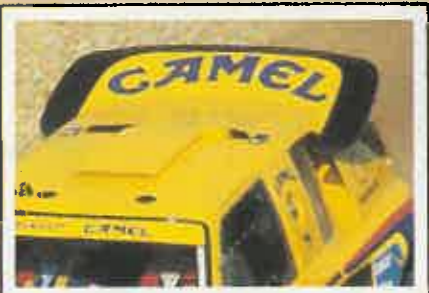
5 Gran deflector aerodinámico, que proporciona estabilidad a la carrocería a grandes velocidades. Al ir tan adelantado produce una turbulencia que impide la entrada de polvo desde atrás.
