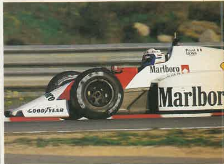
El campeón del mundo tenía comunicación directa con los boxes. Tras el casco, la antena del emisor-receptor montado en el McLaren.
