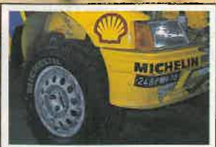
2 Llantas de 16 pulgadas sobre las que se han montado los enormes neumáticos Michelin especiales para tierra. Los discos de freno son los empleados en rallyes del mundial.
