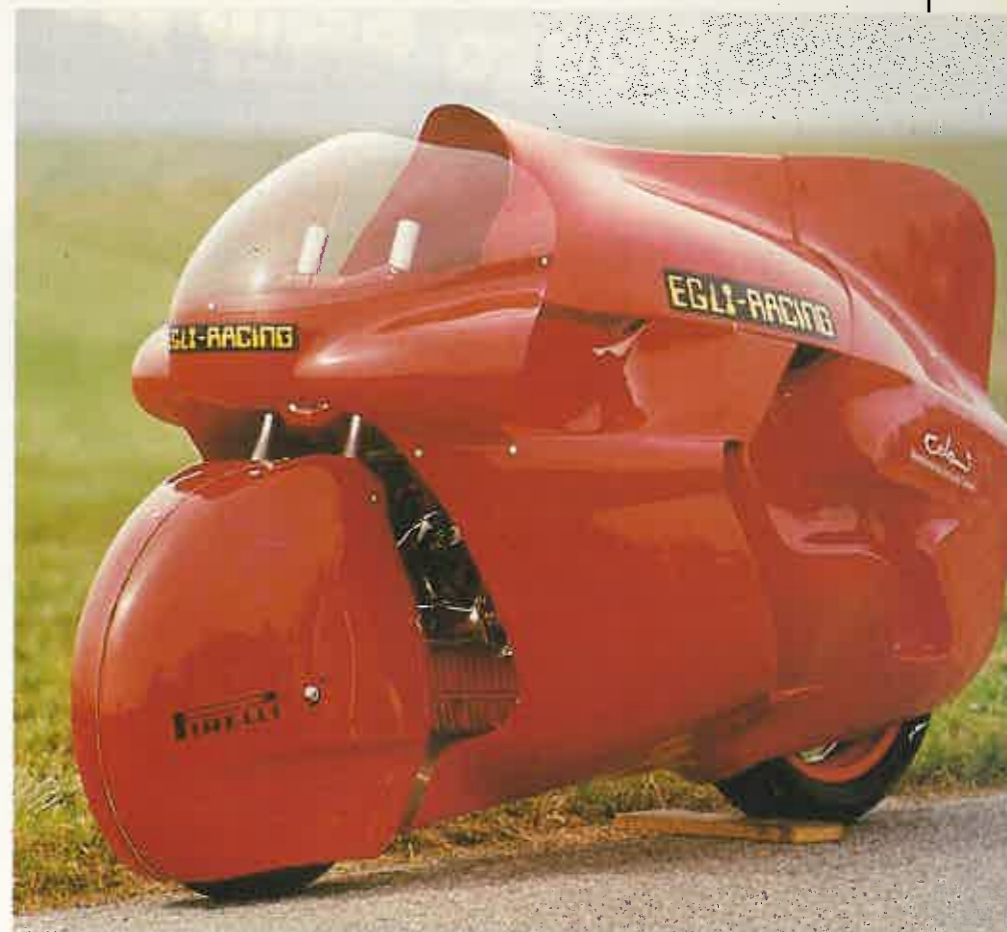
La Egli es hija de dos genios, el diseñador Colani y el motorista Egli. Lleva un motor Kawasaki turboalimentado que da trescientos caballos de potencia.
