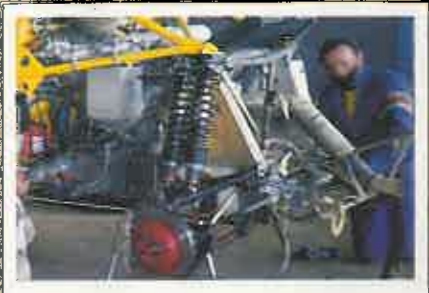
6 Suspensiones tipo Safari triángulos y rótulas modificados. Llevan doble amortiguador y muelle desarrollados por Bilstein para el 205. Son regulables en recorrido y dureza.
