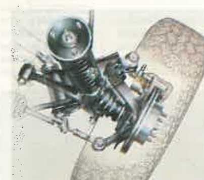
Suspensión delantera MAC PHERSON con tirante superior.
