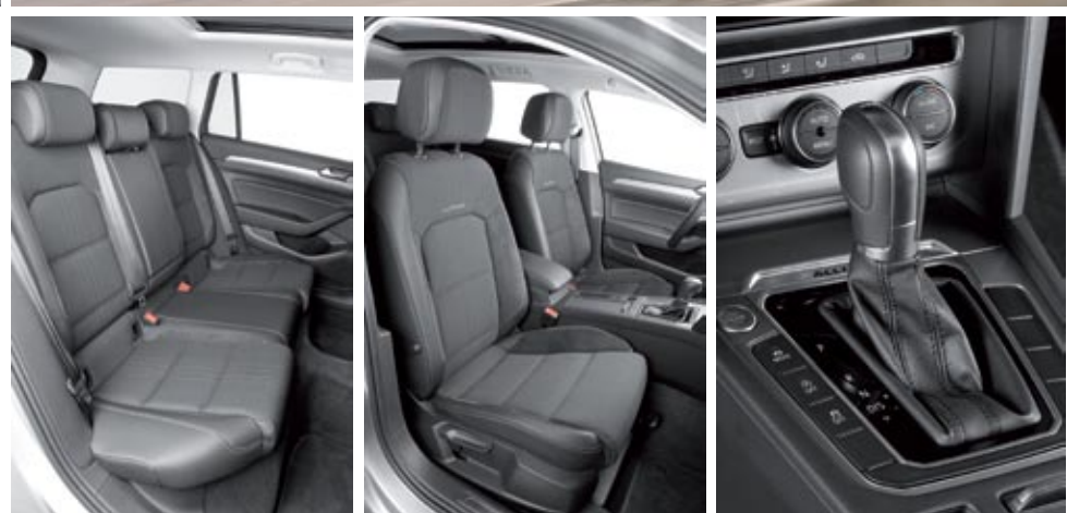
▲ La amplitud interior es sensacional: caben cinco adultos sin problemas y sus respectivos equipajes. Este tapizado es específico y añade los asientos delanteros ergoConfort. El cambio DSG6 es obligado con el motor 2.0 TDI 190. Incluye levas, y en modo ECO ofrece función 'a vela'.
