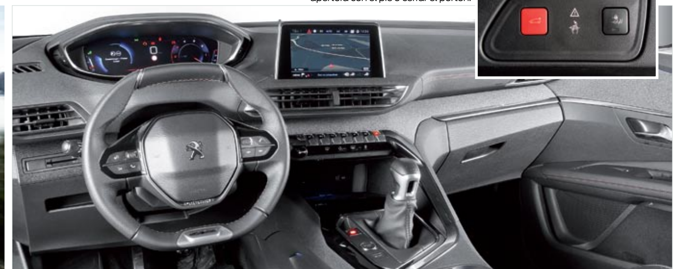
► En el borde del portón trasero, estos dos mandos permiten bloquear la apertura con el pie o cerrar el portón.
