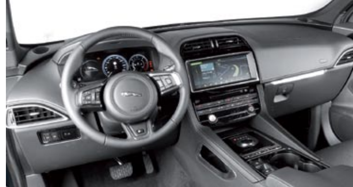
▶▶ El mando giratorio del cambio automático emerge al arrancar. El sistema InControl Touch Navigation es de serie.
