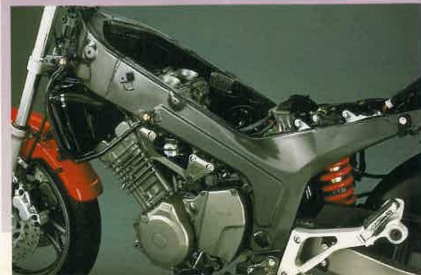
muestra un poco blanda y con un excesivo recorrido. Algo parecido ocurre con el monoamortiguador trasero, a pesar de su posibilidad de reglaje, acusando cierta tendencia al balanceo en las curvas más rápidas. Los frenos se comportan con corrección y no acusan en exceso la fatiga con un uso prolongado, aunque el trasero tiende a clavarse con facilidad.
