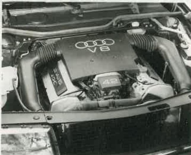
**MAS CILINDRADA EN EL MOTOR V8** Con el incremento de cilindrada, el Audi V8 alcanzará, en las versiones equipadas con este nuevo motor, 280 caballos de potencia. Para aprovechar mejor sus posibilidades, se podrá adquirir, aunque sin pagar sobrepeso, con una caja de cambios de seis velocidades de relación cerrada. El motor turbodiésel de inyección directa vuelve al Audi 100.
