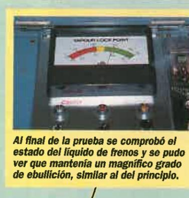
Al final de la prueba se comprobó el estado del líquido de frenos y se pudo ver que mantenía un magnífico grado de ebullición, similar al del principio.
