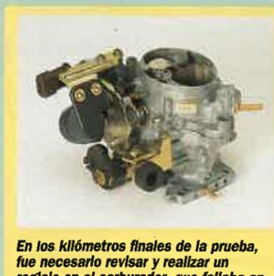
En los kilómetros finales de la prueba, fue necesario revisar y realizar un reglaje en el carburador, que fallaba en caliente.
