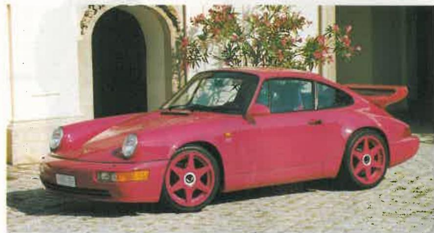
modelos de Porsche Carrera, en la que se ha logrado reducir notablemente el peso original. Para su fabricación, la firma germana ha recurrido al empleo de fibra de carbono y kevlar, así como asientos Recaro ultraligeros (2,5 kilogramos cada uno), llantas Momo de magnesio de 18 pulgadas calzadas con neumáticos Pirelli P Zero y un largo etcétera de complementos especiales.
