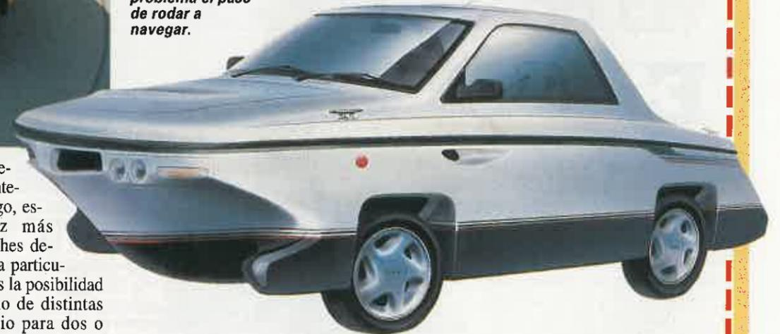
un coche que puede, indistintamente, circular por tierra o por agua con diseño de trimarán.
