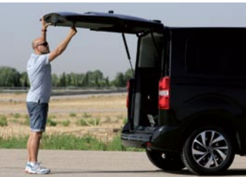
▲▼ La luneta trasera practicable es muy útil y evita tener que abrir el enorme portón cuando el espacio es limitado en la zaga.
