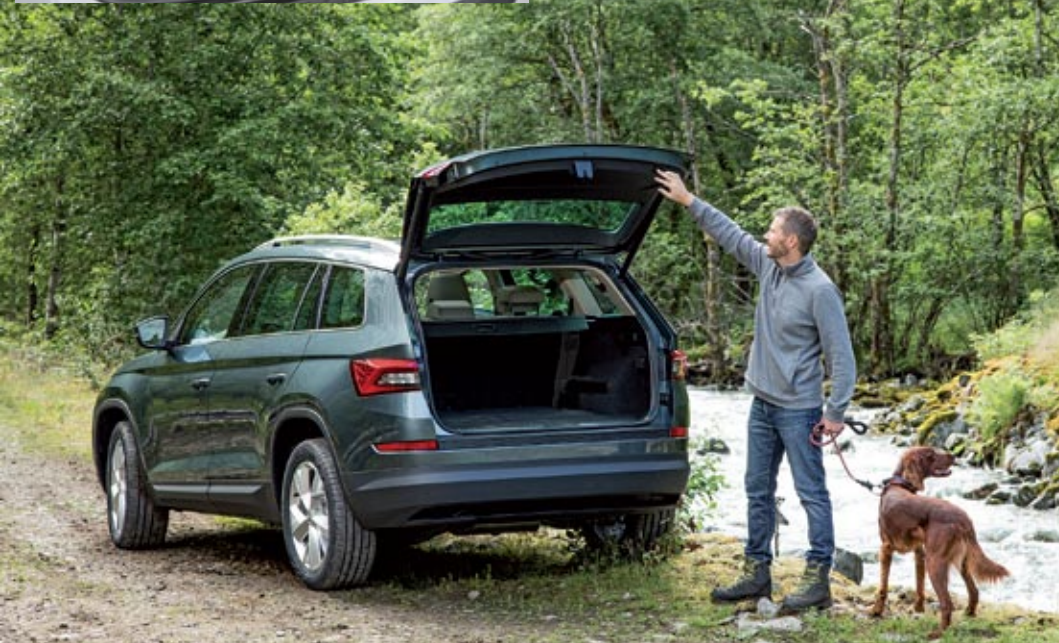
El portón opcional, con apertura y cierre eléctricos, puede integrar también el 'pedal' virtual, que permite abrir pasando el pie bajo el paragolpes.
