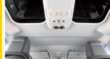
▲ El techo acristalado panorámico es de serie, como la climatización adicional en las plazas traseras. Existen numerosos huecos y guanteras que ofrecen hasta 74 litros extras.
