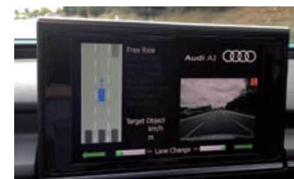
◀ El sistema de 'visión' de Jack analiza lo que pasa 200 metros por delante y por detrás del coche —en color azul en la pantalla izquierda— para adaptar sus reacciones.
