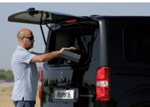
▲▼ La luneta trasera practicable es muy útil y evita tener que abrir el enorme portón cuando el espacio es limitado en la zaga.
