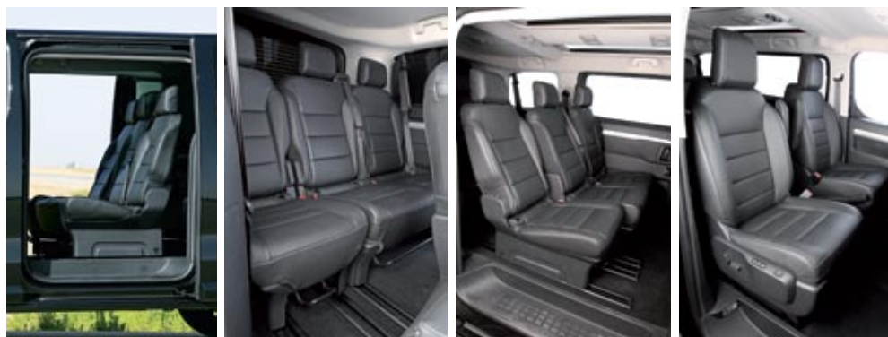
▲ Los ocho asientos están tapizados en cuero de serie. Las butacas delanteras gozan de regulación eléctrica, calefacción y función masaje, mientras que la segunda y tercera fila (60/40) gozan de regulación longitudinal. Las dos puertas laterales correderas son eléctricas y contemplan la función manos libres.
