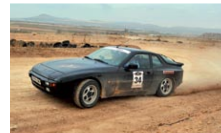
▲ El Porsche 944 llevaba los bajos forrados de acero inoxidable y neumáticos Fedima. El coche gastó 13 l/100 km durante la prueba. Quedó el 112.
