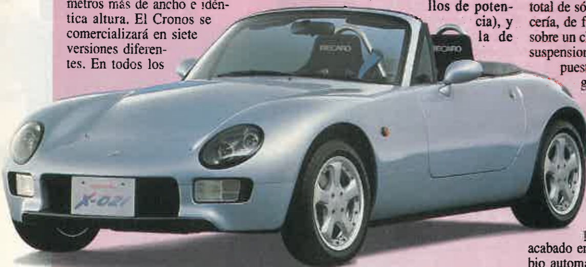
ROADSTER Y BERLINA Arriba. El Daihatsu X-021 tiene chasis tubular y carrocería de fibra. Abajo. El Mazda Cronos, que sustituye al 626.
