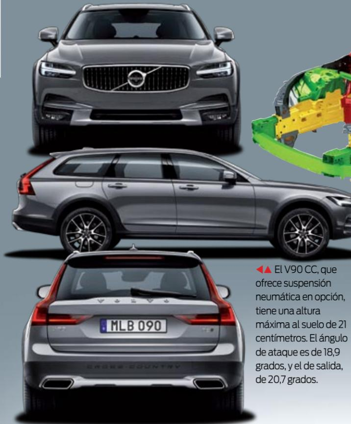
◀ El V90 CC, que ofrece suspensión neumática en opción, tiene una altura máxima al suelo de 21 centímetros. El ángulo de ataque es de 18,9 grados, y el de salida, de 20,7 grados.
