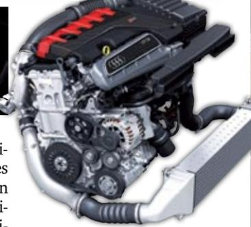
▲ El nuevo motor de aluminio con 5 cilindros y turbo rinde 400 CV.
