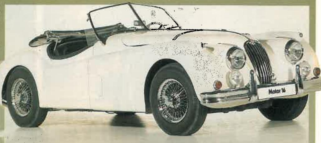
contaba con bastidor tubular, suspensión trasera por barra de torsión y dirección de cremallera. Su motor de seis cilindros en línea y 3.400 centímetros cúbicos proporcionaba una potencia de 200 caballos y el deportivo alcanzaba una velocidad máxima de 230 kilómetros por hora.
