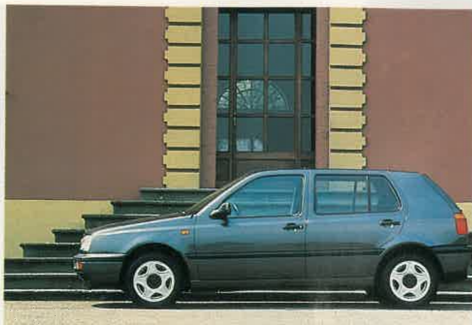
BATIENTE POSTERIOR EXTREMADAMENTE GRANDE Contrariamente a lo que han hecho otros constructores, el Golf tiene un batiente trasero de amplias dimensiones para reforzar una carrocería a la que se ha desprovisto de refuerzo en el borde del portón. La visibilidad ha quedado mermada.
