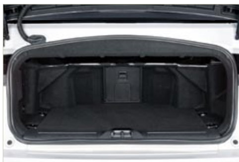
▲ El maletero ofrece 251 litros sea cual sea la posición de la capota. Pero la boca de carga es estrecha y no hay rueda de repuesto.
