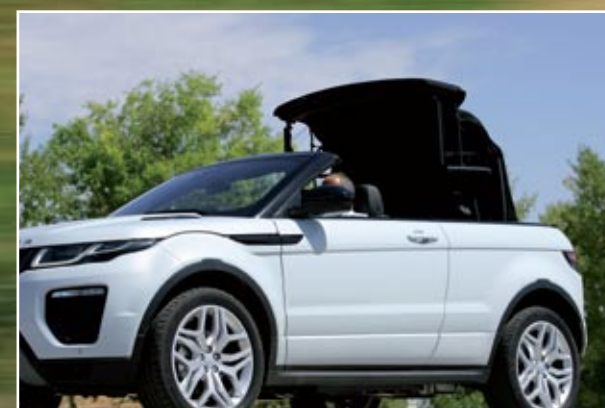
▶▶ La capota de lona eléctrica, que sólo se ofrece en color negro, se quita en 18 segundos y se pone en 21. Ambas operaciones pueden realizarse en marcha, hasta 48 km/h.
