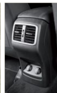
▶▶ Bajo las salidas de aireación traseras del Sportage va una toma de 12V –lleva dos delante– y el segundo puerto USB.
