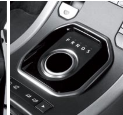
▲ Cambio ZF de nueve marchas con mando giratorio 'emergente'. Y a su lado, el selector para uso 'off road'.
