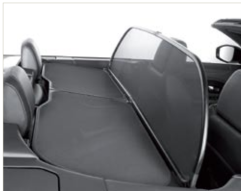
▲ El paraviento es opcional –320 euros– tanto en la versión HSE probada como en la SE, 6.500 euros más barata. Al usarlo, anulamos las dos plazas traseras, y su presencia sólo es determinante a muy alta velocidad. Sin él, incluso a 140 km/h no hay remolinos.
