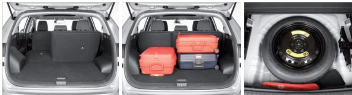
◀ El Cee'd Sportswagon reserva 528 litros para el equipaje, y 1.642 si abatimos el respaldo. Bajo el suelo va la rueda de repuesto, de emergencia como en sus 'hermanos'.
