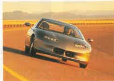
El GM Impact es un prototipo de coche eléctrico, con autonomía de más de 200 kilómetros y una velocidad máxima de 160 kilómetros por hora.
