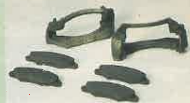
UN POCO BLANDAS Las pastillas con unos forros un poco blandos hubo que sustituirlas poco antes de los 20.000 kilómetros.
