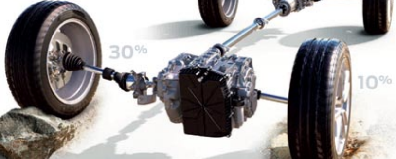
▲ Las versiones dotadas con tracción total envían par de manera automática en función de las necesidades de adherencia. El conductor no hace nada, pero lo puede ver en un display.
