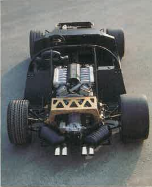
FIBRA DE CARBONO El chasis, que sólo pesa 50 kilos, es de este material. La disposición del motor, la tracción trasera y la implantación mecánica, posibilitan un comportamiento de coche de carreras. Al puesto de conducción no le falta de nada, ni siquiera un equipo de sonido, un JVC diseñado por... Giugiaro.
