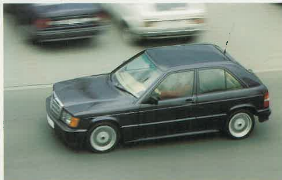
CON LA MISMA LONGITUD DE UN GOLF Conservando la calandra delantera y todos los elementos mecánicos del Mercedes 190, Schulz ha realizado un coche para competir con el Golf.
