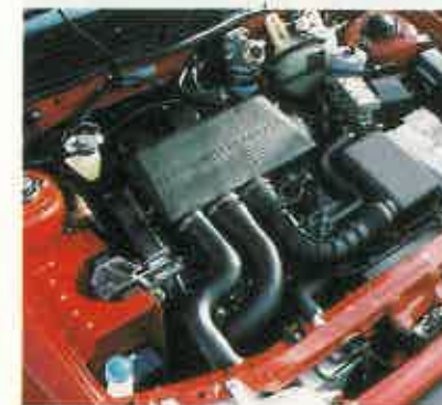
TURBOALIMENTADO El nuevo motor diesel de Rover es de origen Peugeot y proporciona una potencia de 88 caballos.
