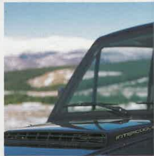
RESPIRADERO A MEDIDA En el capó hay una toma que sirve para refrigerar el intercooler. Los desbloqueadores de las ruedas son automáticos.
