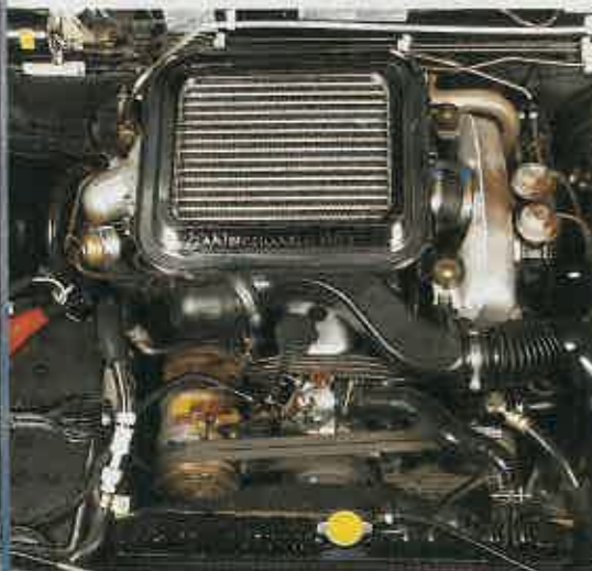
INYECCION DE POTENCIA Gracias a la adopción de un intercambiador de calor, el motor ofrece no sólo un aumento de potencia, sino que además mejora el rendimiento.
