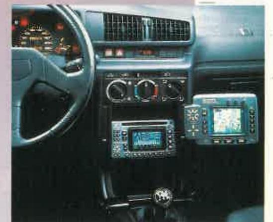
datos al procesador de la pantalla, este los verifica y genera el gráfico del mapa. Estos gráficos se observan en un control visual que posee el conductor. Dispone de una pantalla de cristal líquido de 4 pulgadas en color
