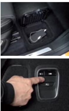
▲ Los detalles prácticos son vitales en un monovolumen. El interior ofrece hasta 63 litros extras divididos en cofres, guanteras, cajones... Los respaldos traseros se abaten automáticamente desde el maletero.
