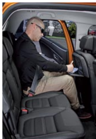
▲ Amplio y luminoso, la habitabilidad y el confort que brinda el nuevo Scénic es excelente. Las tres plazas individuales desaparecen en favor de una banqueta dividida en dos secciones (60/40) que también cuenta con regulación longitudinal. La consola central también se desliza.
