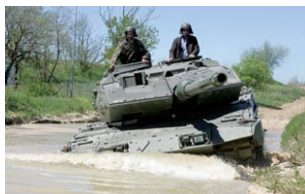
◀ Dispara con un alcance eficaz de 4.000 metros. El vadeo normal es de 120 centímetros; el profundo, de 223, y la inmersión, de 400 con esnórquel.
