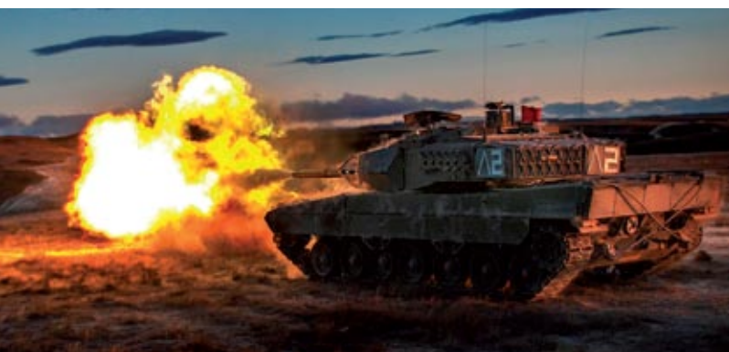
◀ Dispara con un alcance eficaz de 4.000 metros. El vadeo normal es de 120 centímetros; el profundo, de 223, y la inmersión, de 400 con esnórquel.
