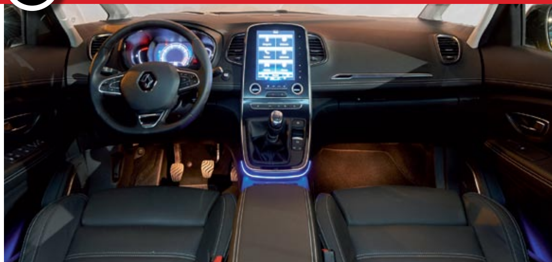
▲ La pantalla táctil de 8,7 pulgadas tipo 'tablet' gestiona buena parte de la información del vehículo.
