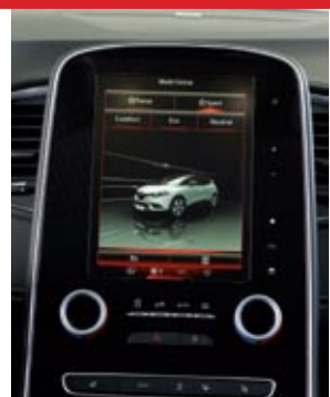
▲ La pantalla táctil de 8,7 pulgadas tipo 'tablet' gestiona buena parte de la información del vehículo.
