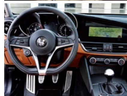
▶▶ Rueda de control del DNA, con modos Normal, Dynamic, Eficiencia avanzada (y Race en el Quadrifoglio) Los relojes del cuadro de instrumentos son tradicionales.
