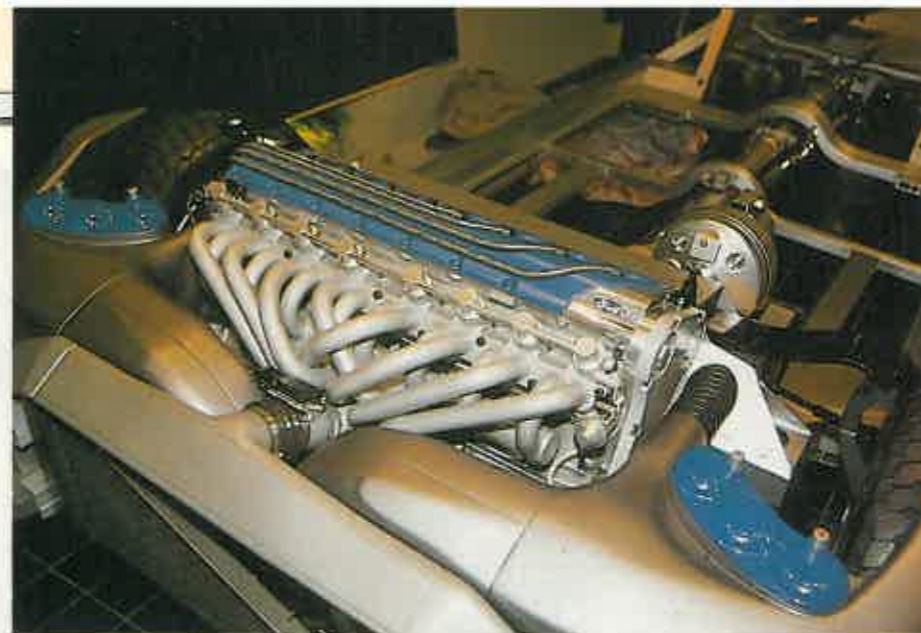
VANGUARDIA TECNOLÓGICA Ford trabaja incansablemente en nuevas soluciones, como el sistema T-drive (transmisión en T). La transmisión y el motor (de ocho cilindros) requieren un espacio mínimo.
