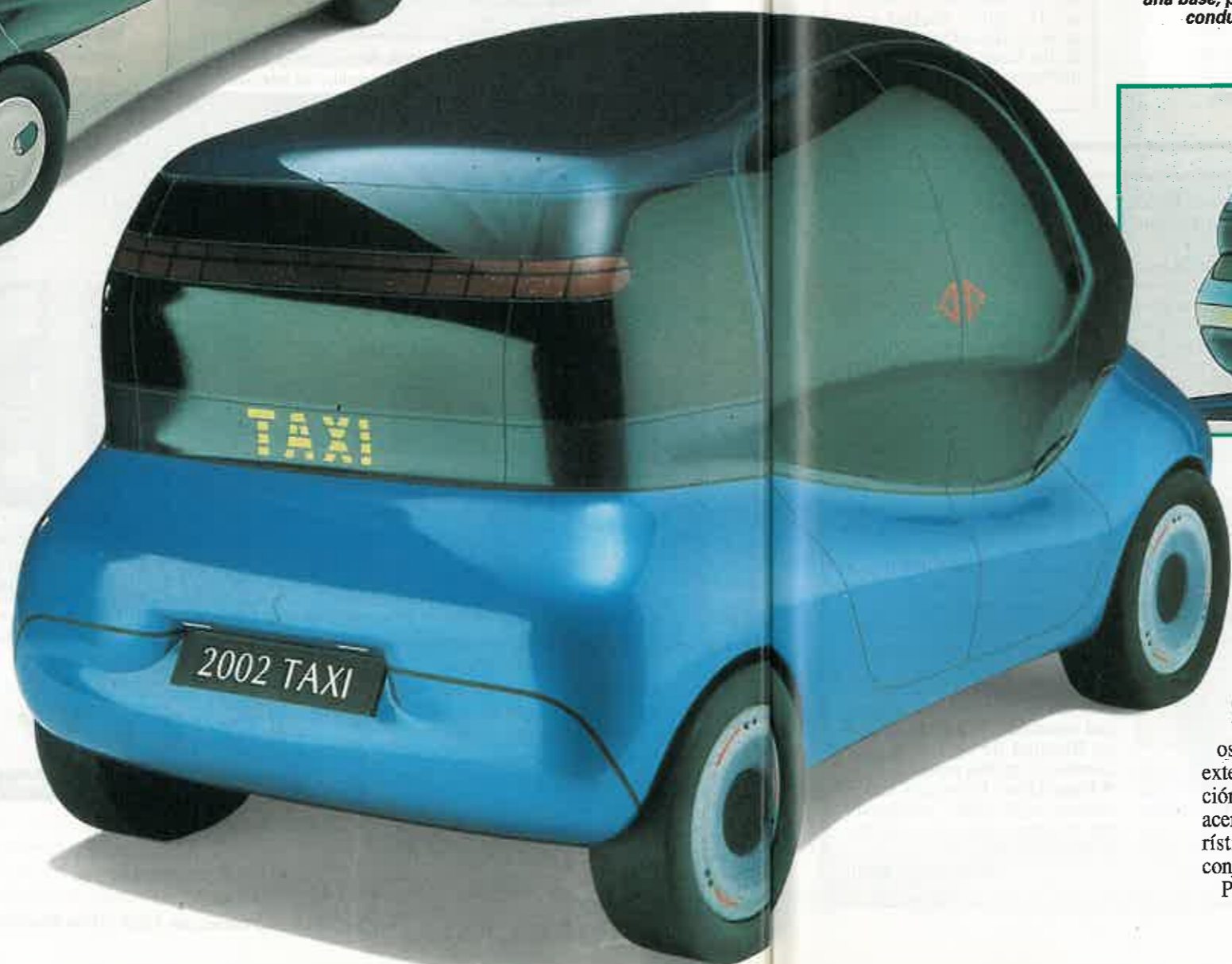
ESTRUCTURA DE VIDRIO El coche de ciudad combina en su estructura el acero con un vidrio especial. Del boceto inicial a la maqueta de tamaño real, el prototipo ha ganado en amplitud.
