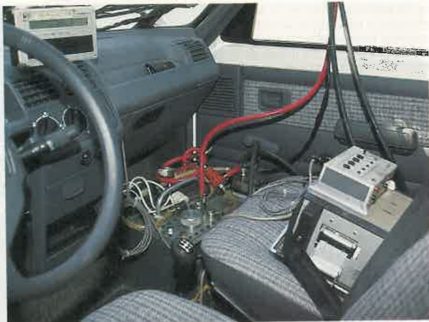
CON AYUDA DEL CORREVIT Este pequeño ordenador es el que normalmente se aplica en las diversas pruebas para comprobar todo tipo de características del producto que se analiza
