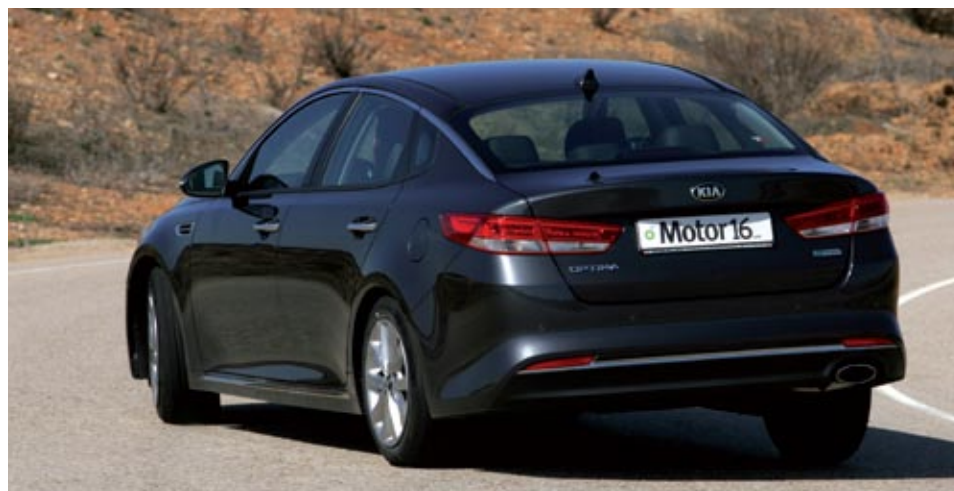
◀ Se echa de menos el portón para cargar objetos voluminosos, pues la boca de acceso mide sólo 44 centímetros de alto. Pero pronto llegará a España el Optima familiar. A la derecha, en pleno apoyo, donde exhibe una nobleza y una agilidad sorprendentes.
