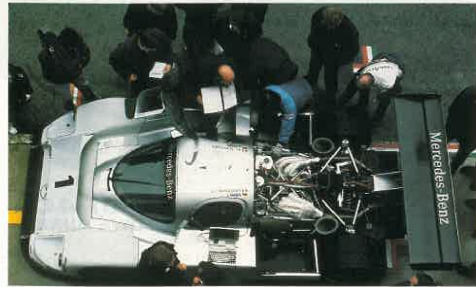
EL MOTOR ATMOSFERICO ES EL PROTAGONISTA DEL MERCEDES C 291. Un nuevo sistema electrónico de TAG Electronics controla la inyección y el encendido.
