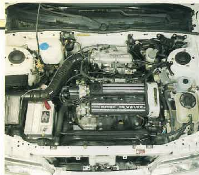
HERENCIA JAPONESA El motor del Rover de origen Honda es el más moderno y sofisticado de los tres. Uno de los logros de la marca ha sido conseguir sacar al motor de 1,6 litros una sensacional potencia de 130 caballos.
