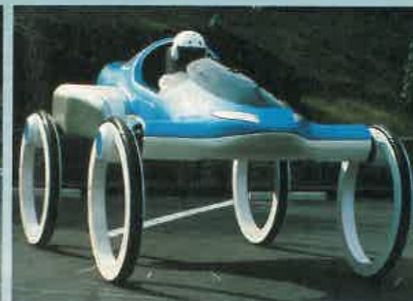
VIAJERO COSMICO ...O pequeño saltamontes, porque puede superar cualquier obstáculo. La altura la elige el conductor, lo mismo que la inclinación, hacia delante o hacia atrás.
