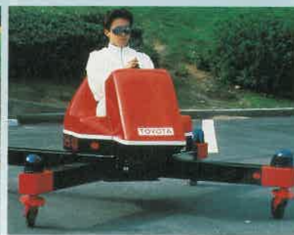
SWIMOBILE Un sistema de control electrónico hace que se mueva a la misma velocidad que «nada» el conductor. Si no nada, no anda. A la derecha, el Superdeslizador tipo tijera.
