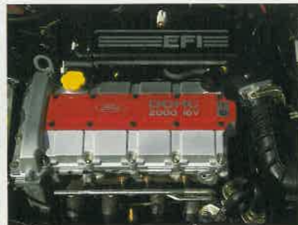
DIECISEIS VALVULAS PARA EL ESCORT La versión XR3i del Ford Escort ya está más cerca. Su motor desarrolla 150 caballos de potencia.
