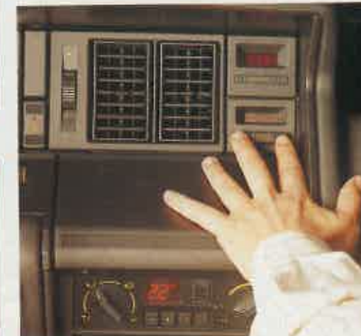
PARA UNA EMERGENCIA El diferencial trasero se bloquea apretando este botón.
