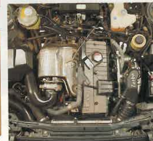
TECNOLOGIA PUNTA El motor, que es de dos litros, está sobrealimentado por un turbocompresor.
