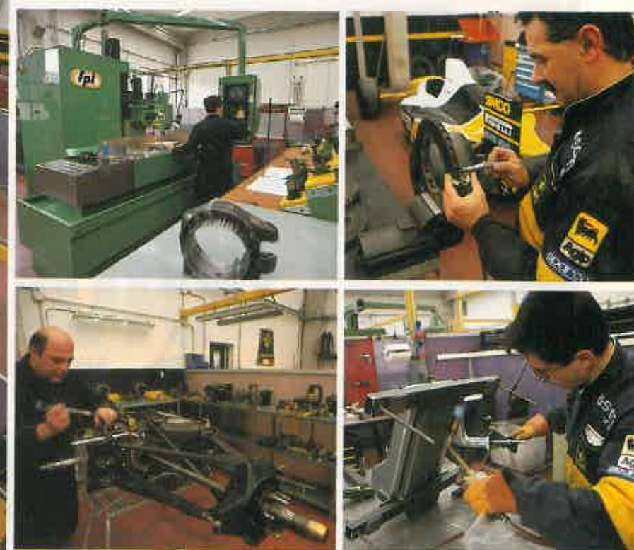
LA PRECISION COMO NORMA En la foto a la izquierda se aprecia la magnitud y la organización que reina en el departamento de producción. Los tornos de control digital están conectados a los ordenadores de la oficina técnica. Frenos, amortiguadores y cambios, están controlados con el máximo rigor.
