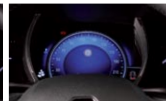
▲► El sistema Multi-Sense permite personalizar la información principal del cuadro, los colores de la iluminación del habitáculo, los modos de conducción y un largo etcétera. En el modo ECO la iluminación se vuelve verde y esa configuración permite reducir los consumos notablemente.
