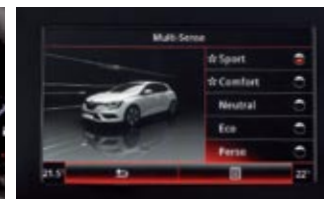
▲► El sistema Multi-Sense permite personalizar la información principal del cuadro, los colores de la iluminación del habitáculo, los modos de conducción y un largo etcétera. En el modo ECO la iluminación se vuelve verde y esa configuración permite reducir los consumos notablemente.
