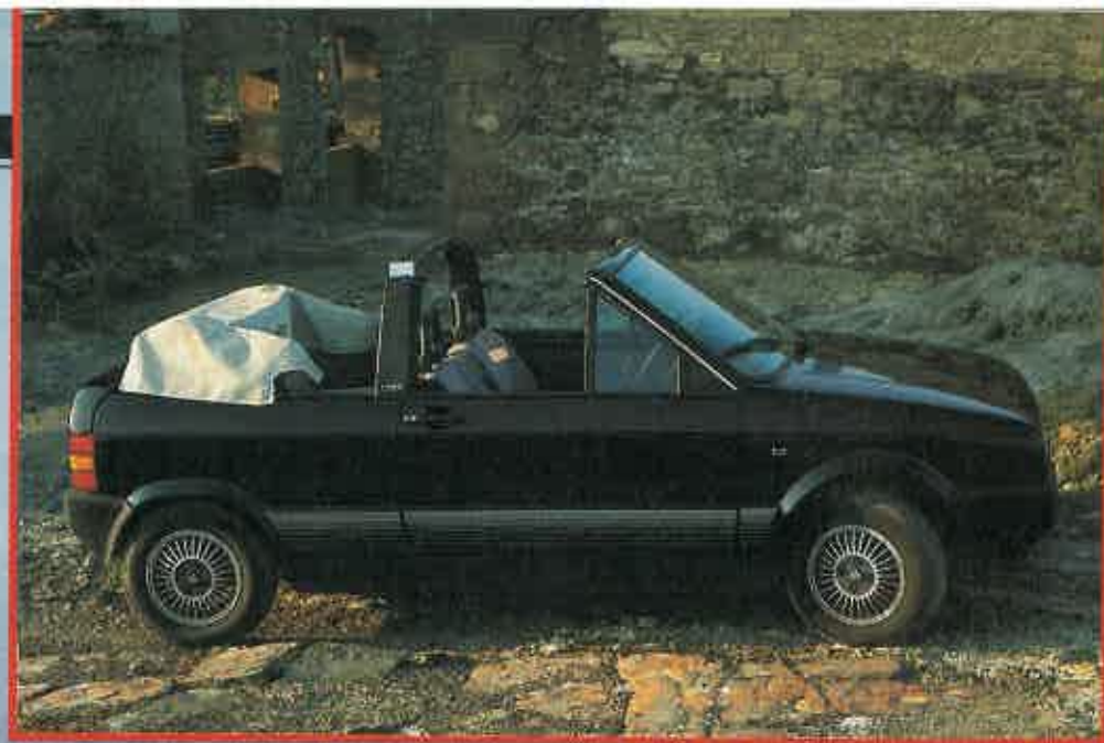
El nuevo modelo no ha perdido ninguna de sus características mecánicas y su rigidez es la misma del modelo base. La capota tiene tres capas; la del centro actúa como aislante. Esta capota se pliega con toda facilidad.
