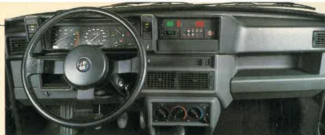
El Salpicadero es el mismo que en otras versiones del Alfa 75. En el cuadro de instrumentos aparece el manómetro de presión del turbo. El volante va forrado de piel.
