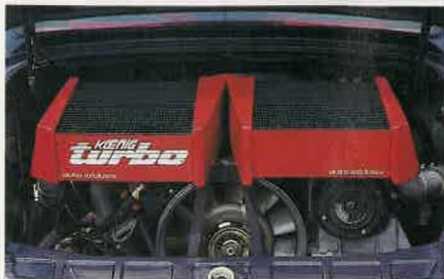
Este es el corazón del 911 Koenig. Un motor seis cilindros planos alimentado por dos turbos.
