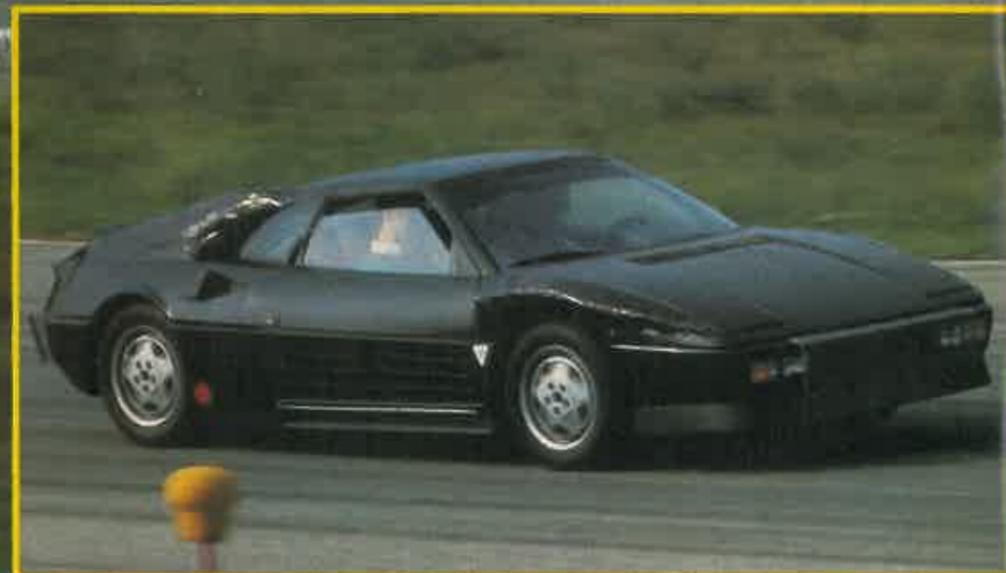
Carrocería estudiada en el modernísimo túnel de viento de Ferrari. Se espera un coeficiente de penetración aerodinámica cercano al 0,28.
