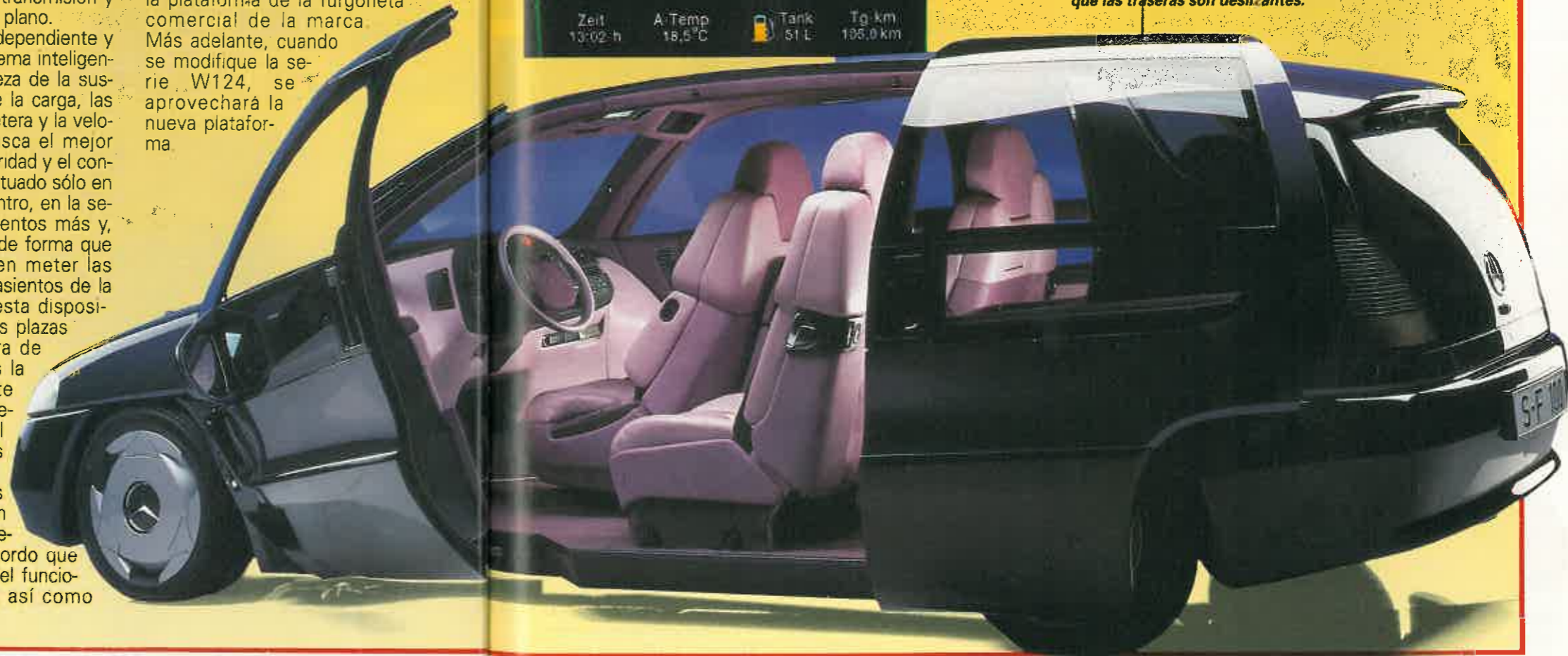
ACCESO LIBRE Las puertas delanteras se abren hacia arriba, mientras que las traseras son deslizantes.
