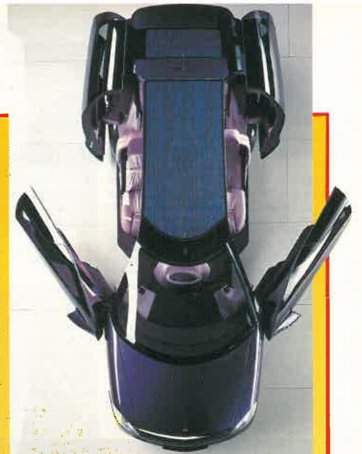
ACCESO LIBRE Las puertas delanteras se abren hacia arriba, mientras que las traseras son deslizantes.
