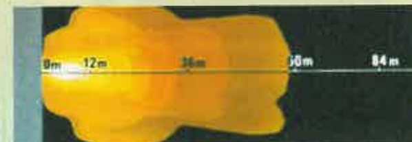
Antiniebla. Corte horizontal neto, distancia de iluminación entre 50 y 60 metros.
