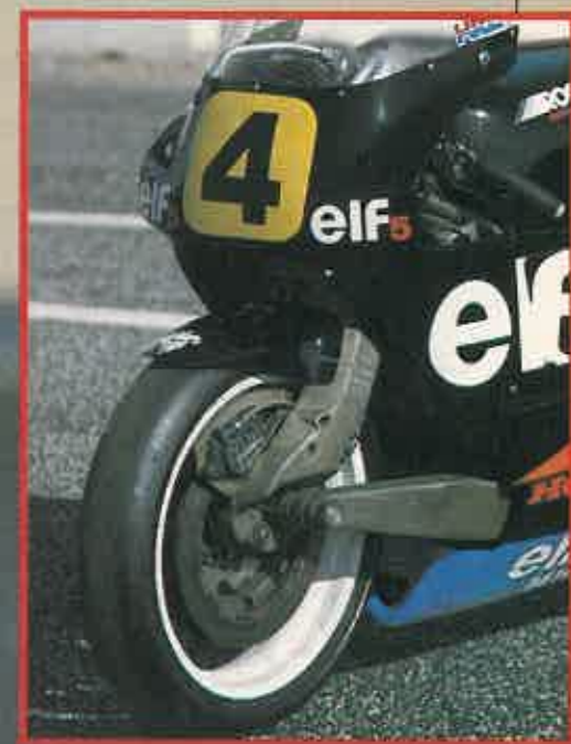
La suspensión trasera monostraza y la suspensión delantera de Variación Geométrica Controlada son las características más revolucionarias de las Elf. La Honda ya se fabrican motos con estos sistemas.
