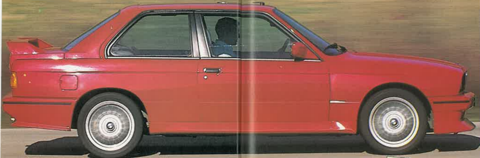
En el nuevo spoiler se han suprimido los faros antiniebla para refrigerar mejor los frenos. Las llantas son de 7,5 x 16 pulgadas con neumáticos de perfil 45. A la derecha, los 220 caballos bajo los llamativos colátes de Motorsport.
