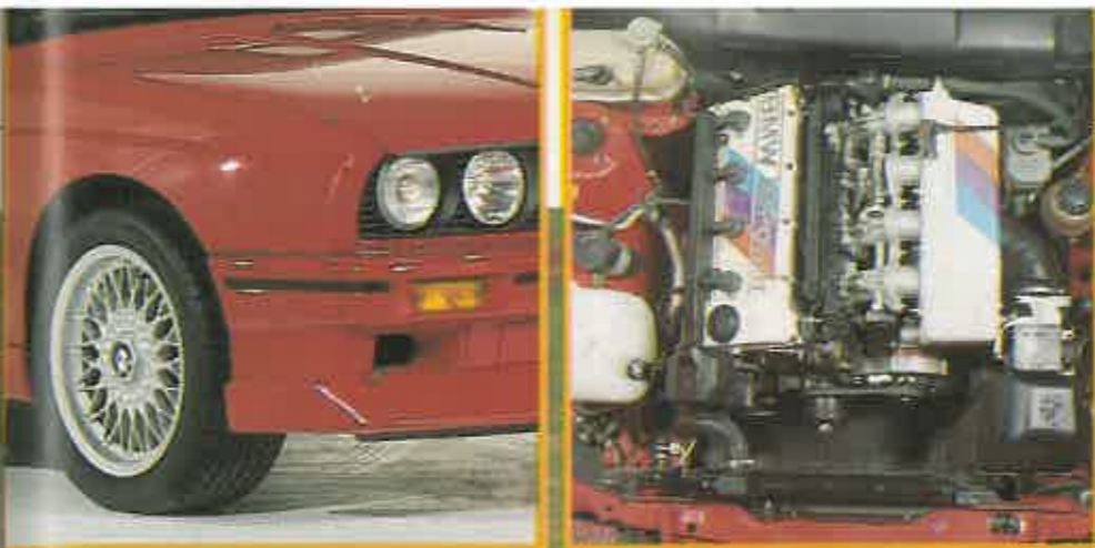
En el nuevo spoiler se han suprimido los faros antiniebla para refrigerar mejor los frenos. Las llantas son de 7,5 x 16 pulgadas con neumáticos de perfil 45. A la derecha, los 220 caballos bajo los llamativos colátes de Motorsport.
