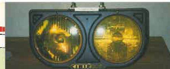
Conjunto de faros auxiliares de larga distancia fabricados por Cibié.
