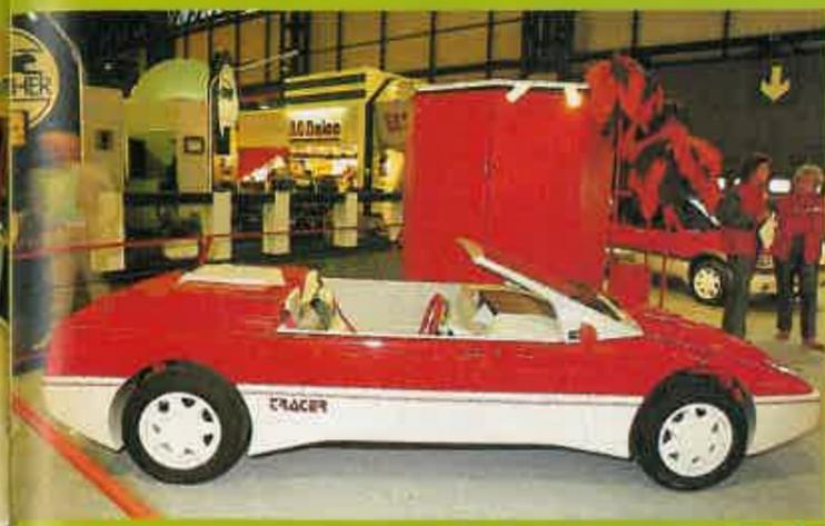
El Tracer es el resultado de un cuidadoso trabajo artesanal. Dentro de un chasis tubular, que esconde la carrocería, se aloja la mecánica del MG Metro Turbo.
