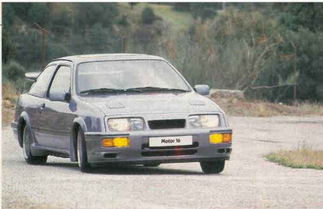
La carrocería del Sierra apenas balancea, aún en los apoyos más fuertes. Al comportamiento, sin embargo, hay que hacerle una crítica: el eje delantero se muestra perezoso a la entrada de las curvas, sobre todo si éstas son lentas. Corregir este defecto a alta velocidad requiere unas buenas dotes al volante.
