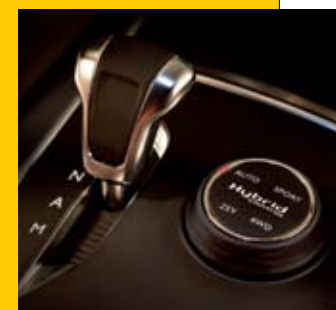
▲ Se puede elegir entre los modos Auto, Sport, 4WD (4 ruedas motrices) y ZEV (Zero Emission Vehicle).
