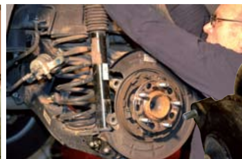
◀▶ Tanto el amortiguador del esquema McPherson delantero (a la derecha), como el del eje trasero (sobre estas líneas) se encontraban con una vida útil elevada. En concreto un 92 por ciento el delantero y un 96 por ciento el trasero.
