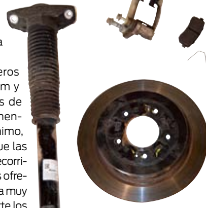
▲ Amortiguadores, discos de freno y pastillas han sufrido el desgaste normal. Destacar que tras 30.000 kilómetros hemos cambiado los neumáticos delanteros al límite ya de desgaste.
