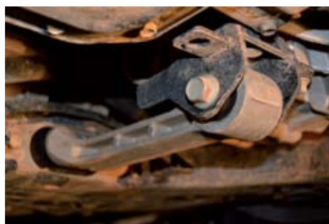
▲ Uno de los soportes del motor que tan buen resultado está dando. Porque apenas llegan vibraciones al habitáculo. Y la sonoridad es baja.
