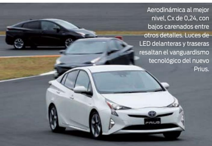
Aerodinámica al mejor nivel, Cx de 0,24, con bajos carenados entre otros detalles. Luces de LED delanteras y traseras resaltan el vanguardismo tecnológico del nuevo Prius.
