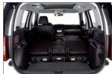
▲▲ Con cinco plazas en uso, el maletero oscila entre 416 y 510 litros. Y alcanza los 1.760 abatiendo todo. El modo 'Offroad' incrementa la seguridad lejos del asfalto.
