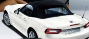
▶ La capota de lona se acciona de forma manual. Entre los asientos va el paraviento.
