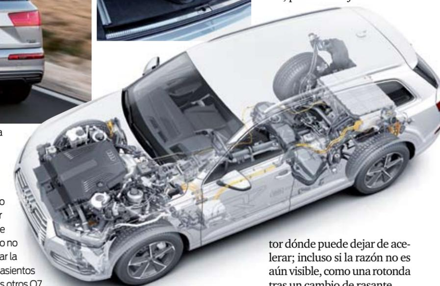
▲ La batería de iones de litio, que pesa 202 kilos, va sobre el eje trasero pero no impide ofrecer un maletero de 650 litros. Pero no permite montar la tercera fila de asientos opcional en los otros Q7.
