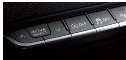
▲ El 'drive select' se puede seleccionar directamente desde el salpicadero. Y la tecla que modifica el sistema Virtual Cockpit.
