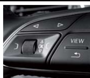
▲ El 'drive select' se puede seleccionar directamente desde el salpicadero. Y la tecla que modifica el sistema Virtual Cockpit.
