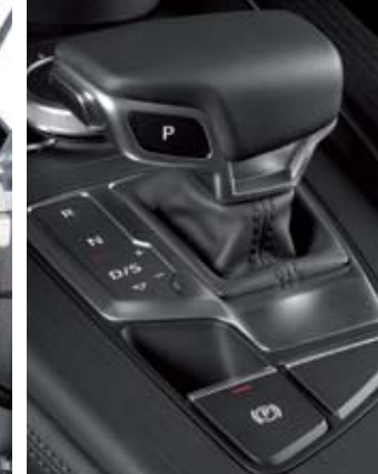
▲ El nuevo pomo del cambio automático S Tronic lleva incorporado la P.
