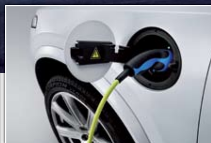
◀ La batería de 9,2 kWh del XC90 T8 se puede cargar en un enchufe doméstico. La recarga completa lleva 2,5 horas si la intensidad de la red es de 16 amperios, 3,5 horas con 10 amperios y 6 horas con sólo 6 amperios.
