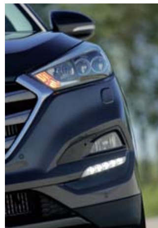
▲ Nuestra unidad va equipada con faros LED para las luces de cruce y de día, y de halógenos para las luces de carretera.
