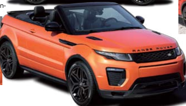
▶ La capota de lona se repliega en 18 segundos y se pone en 21. El maletero cubica 251 litros siempre.
